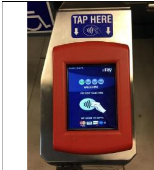
研發測試中之匣門可供信用卡直接感應
