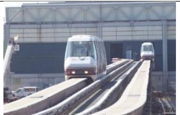
連結機廠出入口之軌道，可見軌道面之寬度及供電用之第三軌
