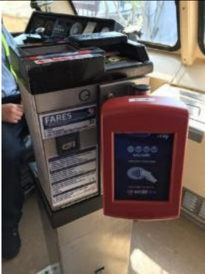
快速輕軌車內自動化票證系統，接受多元支付方式。
