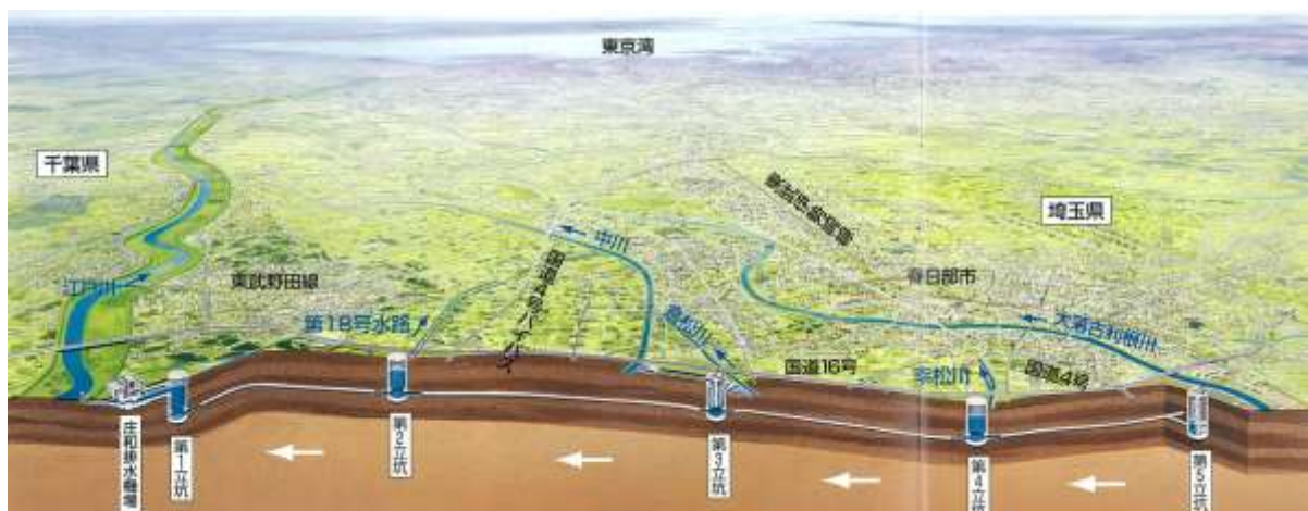
圖 12 排水設施與鄰近水路關係示意圖(二)
