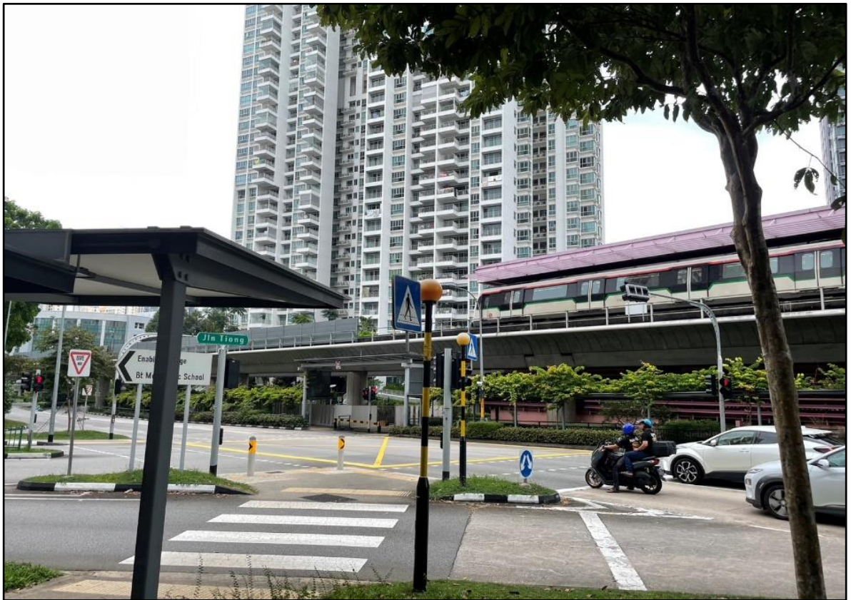
圖41 捷運紅山站前進入社區路口處，透過路型調整及標誌，降低進入社區的車速並提醒車輛注意行人
