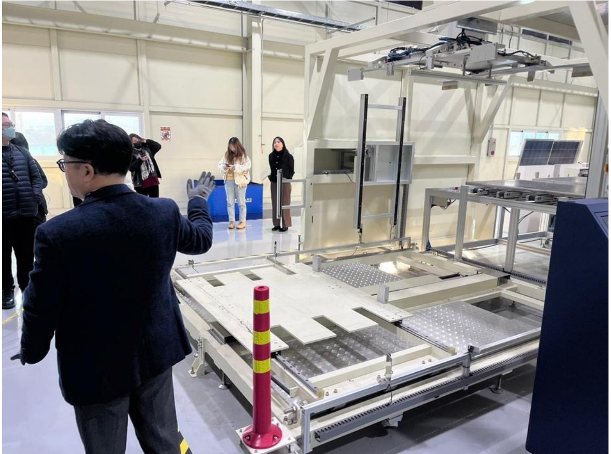
圖 72 廢太陽光電模組回收處理流程-鋁框架拆卸設備
