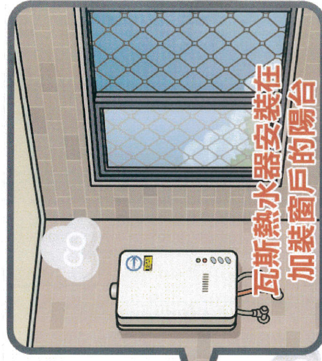
屋外式瓦斯熱水器 安裝在窗戶緊閉的陽台
