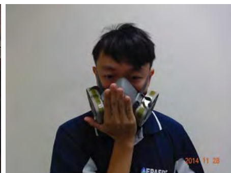
5.進行氣密測試- 正壓測試
