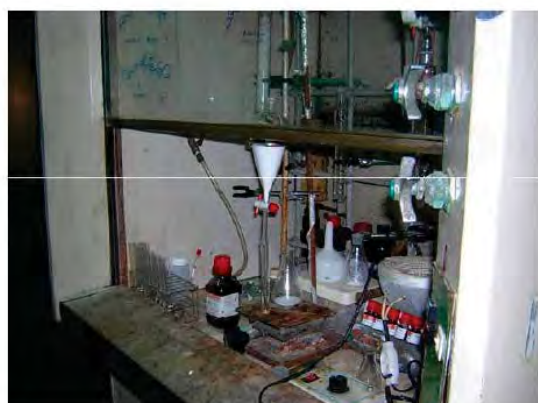
排氣櫃中擺放過多物品，影響排氣氣流
