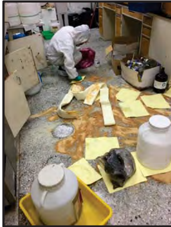
摧腐靈中和劑鋪面 後再以吸收棉吸附
