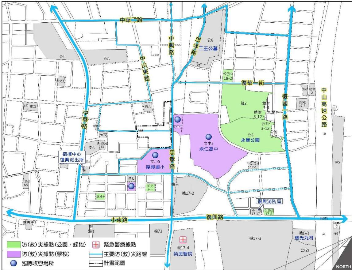
圖 25 防災系統構想示意圖
