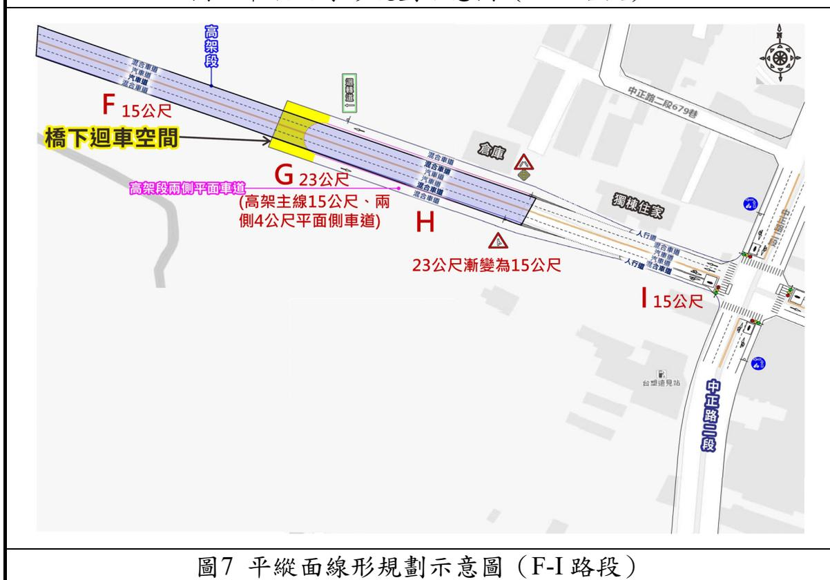
圖7 平縱面線形規劃示意圖 (F-I 路段)
