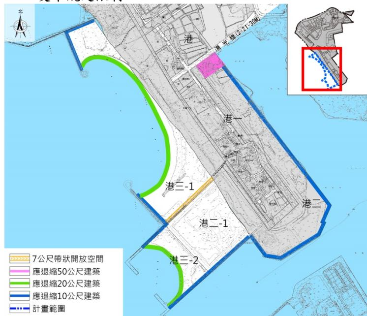
圖 1 退縮建築及指定留設開放空間示意圖
