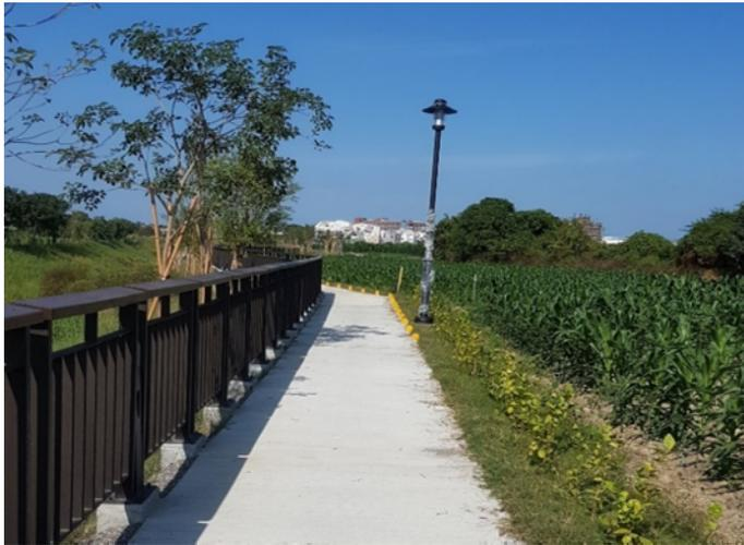
圖 4 步道防滑材質，平順且設有反光導標
