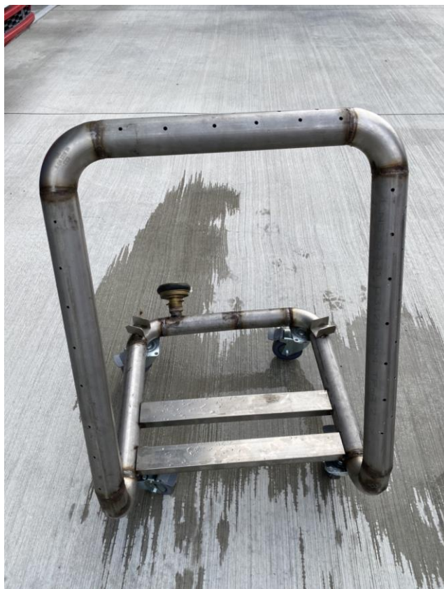
圖 3 可拆卸移動式多功能砲塔底下安裝煞車輪
