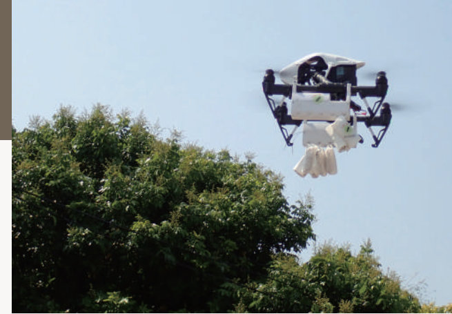
圖20. 利用無人機投放平腹小蜂卵片，進行生物防治，殺死荔枝椿象卵（苗栗區農業改良場提供）。
