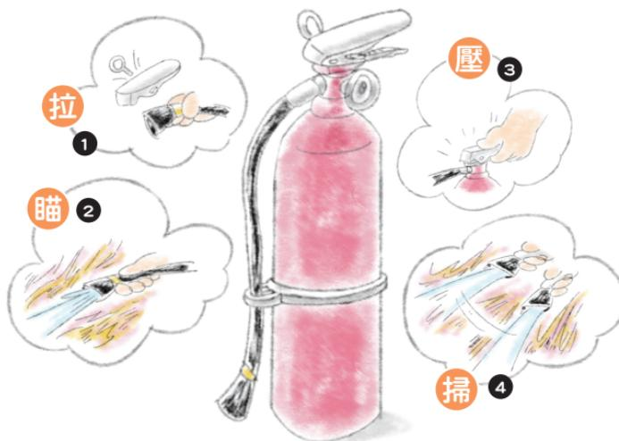
**拉** 1、拉（轉斷）保護套拔出插梢及皮管
