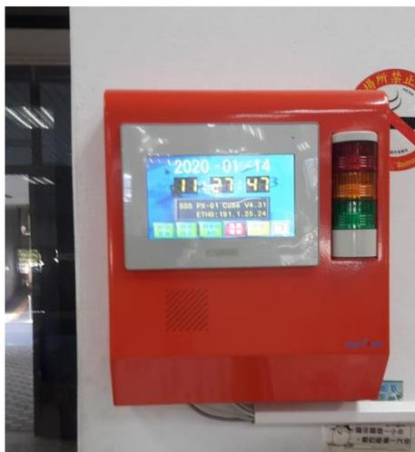
「Cube 地震警報終端裝置」，是應地震預警系統後端需求而產生的警報裝置，能整合中央氣象局地震速報網、PX-01 監控主機與 Palert(P 波地震儀)，於地震發生第一時間發布地震預警訊息，是一套智慧化的現地地震警報器自動化系統，不僅能進行地震預警、強震到達倒數計時或是現地 P 波預警、S 波告警顯示現地震度，也能顯示文字信息，
