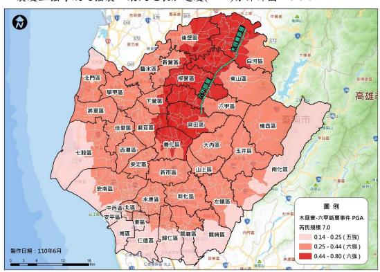
圖 1-3-3-5 木屐寮-六甲系統斷層地震最大地表加速度(PGA)分佈圖
