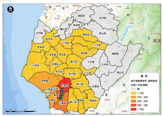
圖 1-3-3-14 後甲里斷層地震事件下各區全半倒棟數分布圖
