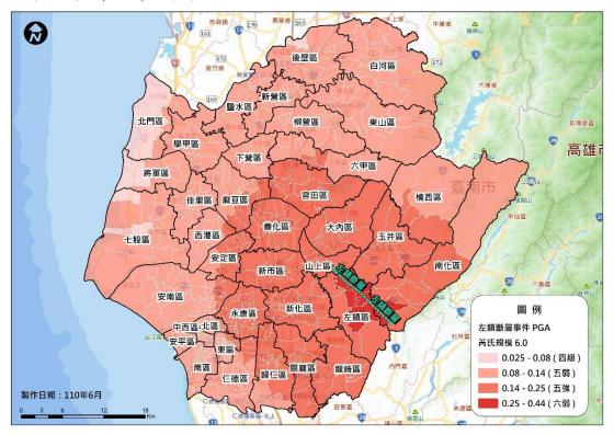
圖 1-3-3-7 左鎮斷層地震最大地表加速度(PGA)分佈圖
