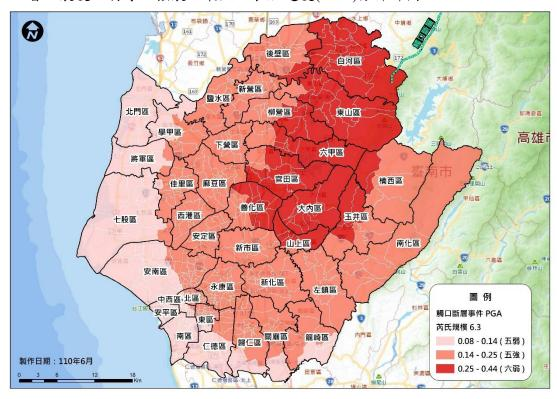
圖 1-3-3-3 觸口斷層地震最大地表加速度(PGA)分佈圖
