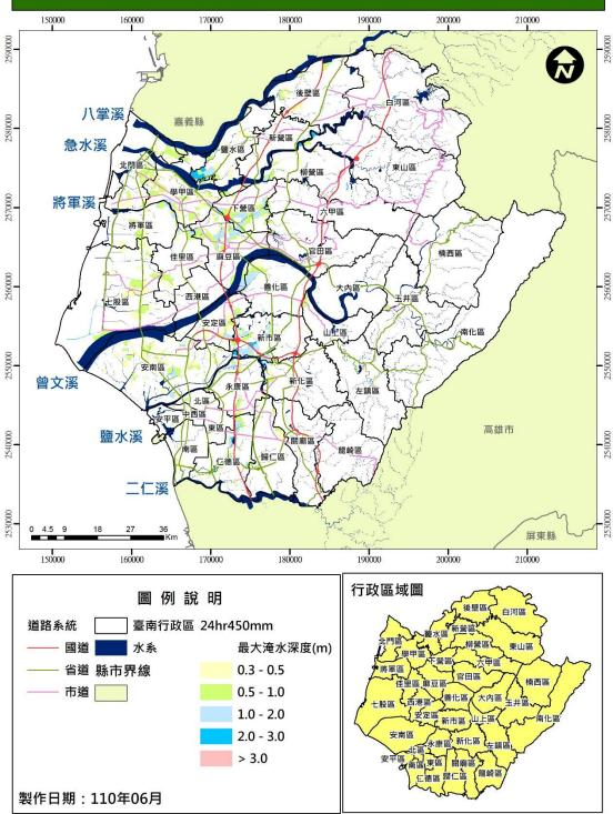
資料來源:依據「109-110年度颱洪應變、預警分析與防災工作」繪製 圖 1-3-1-4 模擬日雨量 450 毫米事件最大淹水深度圖
