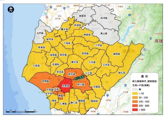
圖 1-3-3-10 新化斷層地震事件各區全半倒棟數分布圖
