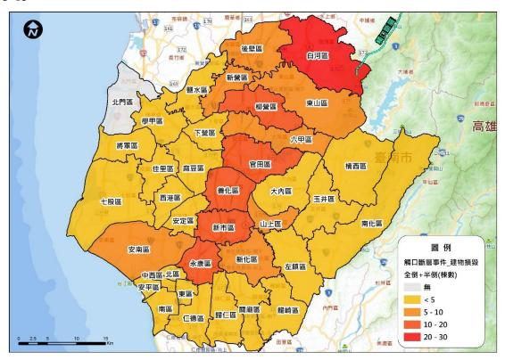
圖 1-3-3-8 觸口斷層地震事件各區全半倒棟數分布圖
