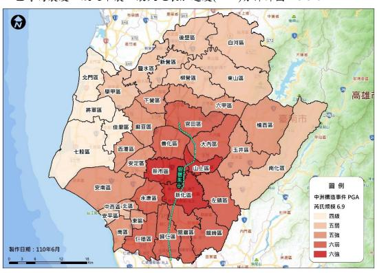
圖 1-3-3-8 中洲構造地震最大地表加速度(PGA)分佈圖
