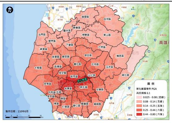
圖 1-3-3-4 新化斷層地震最大地表加速度(PGA)分佈圖
