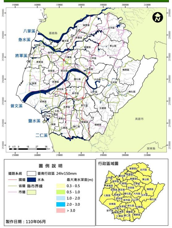
資料來源:依據「109-110年度颱洪應變、預警分析與防災工作」繪製圖 1-3-1-2 模擬日雨量 150 毫米事件最大淹水深度圖
