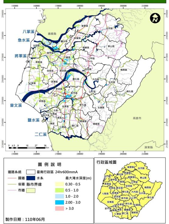
資料來源:依據「109-110 年度颱洪應變、預警分析與防災工作」繪製圖 1-3-1-5 模擬日雨量 600 毫米事件最大淹水深度圖
