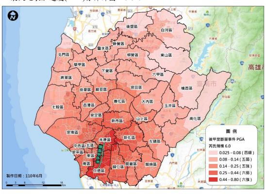
圖 1-3-3-6 後里斷層地震最大地表加速度(PGA)分佈圖
