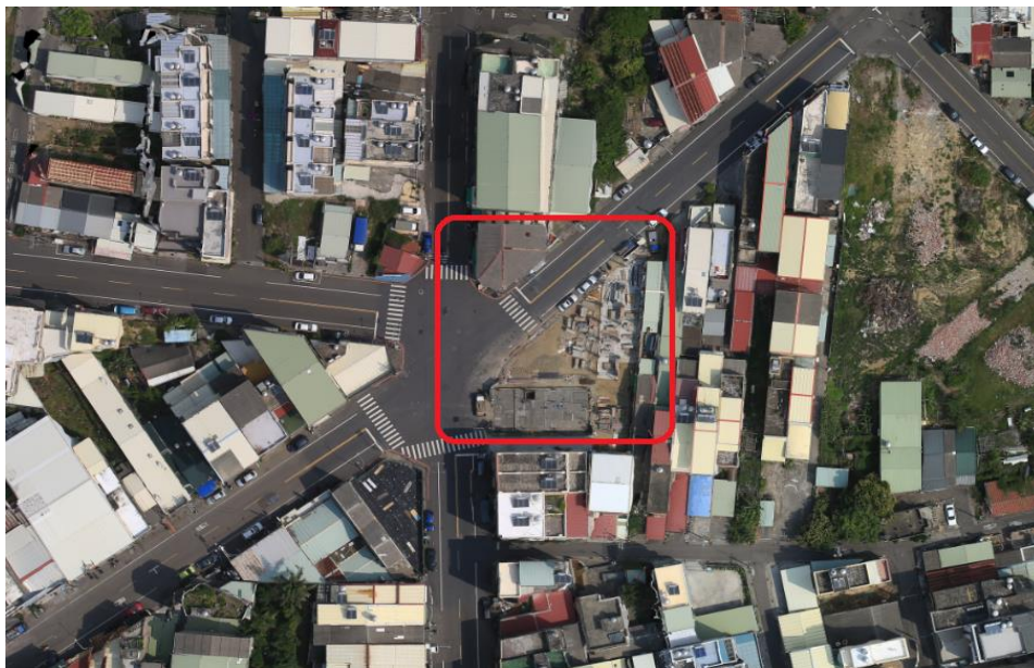
圖 15：UAV 空拍搭配土地複丈系統進行「幸福大樓」重建座標套圖
