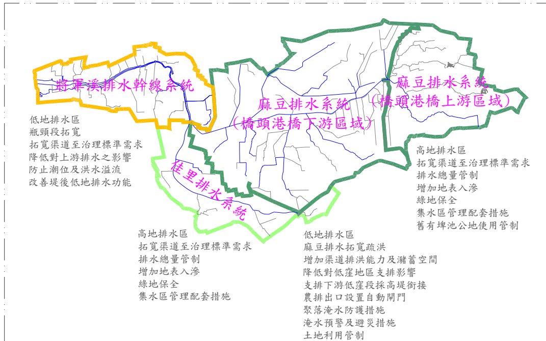
圖 5.1 將軍溪排水系統分區治水策略示意圖
