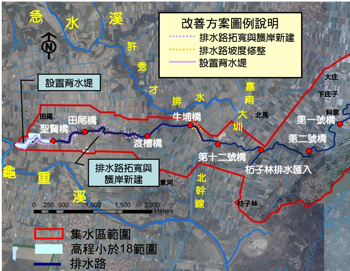
圖 3-3 吉貝要排水改善方案工程布置示意圖(方案 2)
