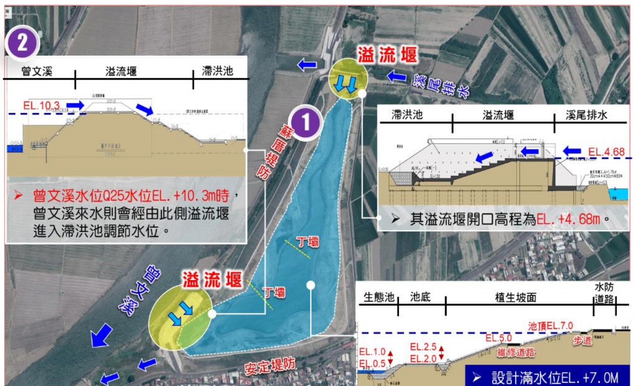
圖12 滯洪池設計運作概要示意圖
