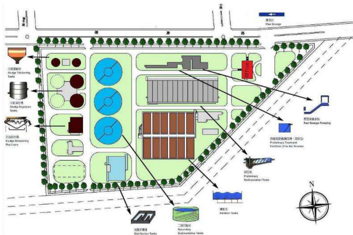
圖 3 安平水資源回收中心配置圖
