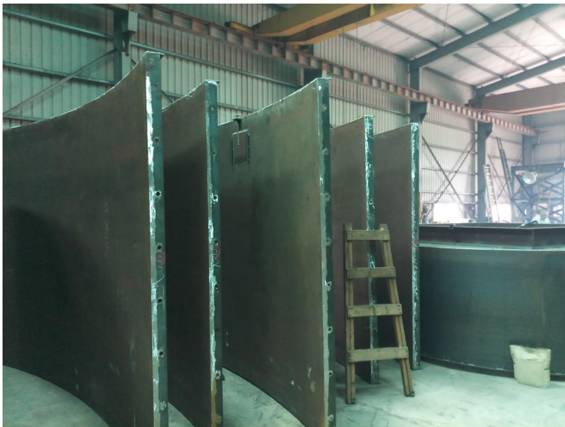
「主軸旋轉箱」構件工廠加工照片
