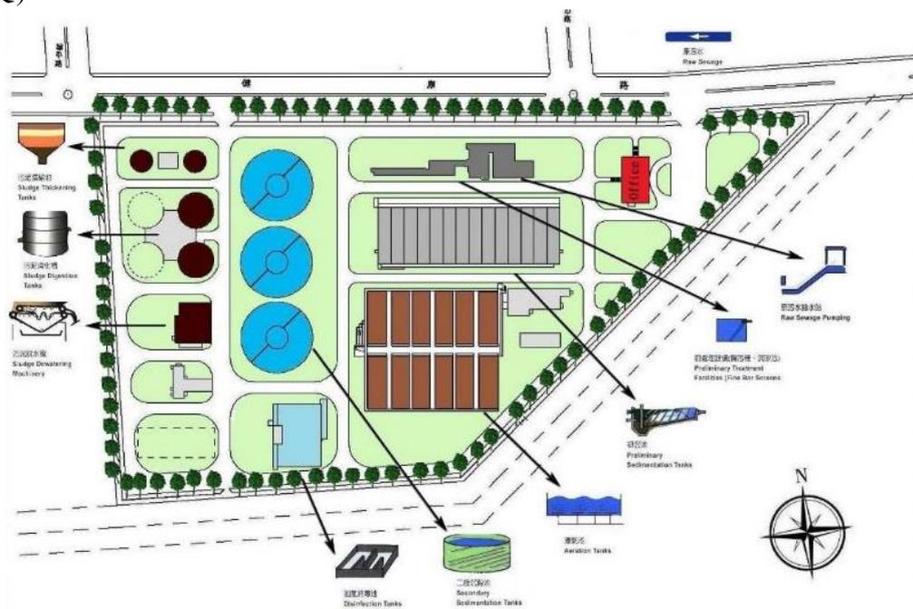
圖 1-3 安平水資源回收中心配置圖
