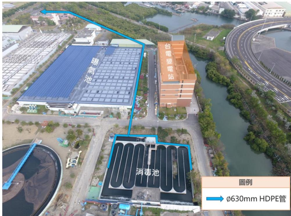
圖 4-12 安平水資源回收中心廠內輸水管線路徑示意圖
