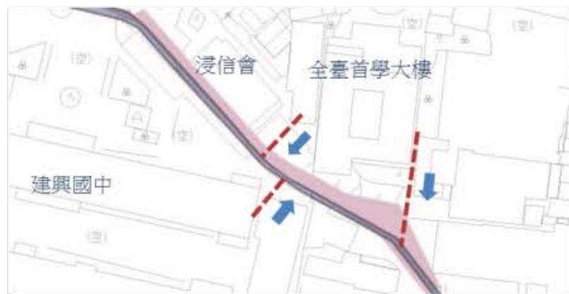
圖4-32 建興國中東段生活污水排入位置(如紅色虛線標示)
