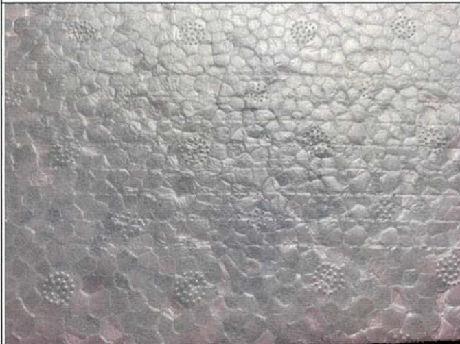
附圖十：測試樣品照片(剖面觀察-1處發泡不完全。)
