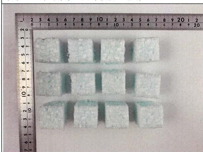
附圖六：測試前樣品照片(刮痕試驗)
