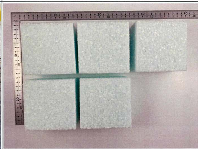
附圖三：測試樣品照片(壓縮試驗)
