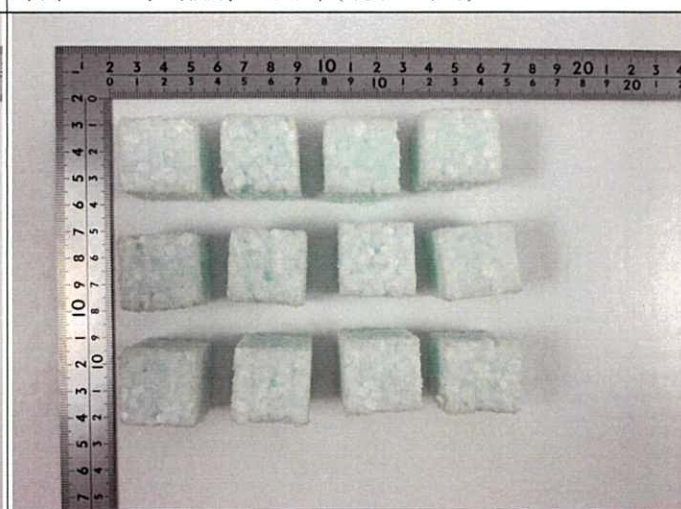
附圖七：測試後樣品照片(刮痕試驗)
