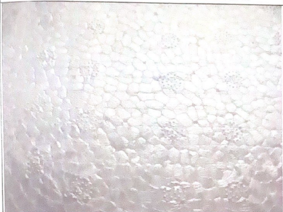
附圖十：測試樣品照片(剖面觀察-發泡完全)
