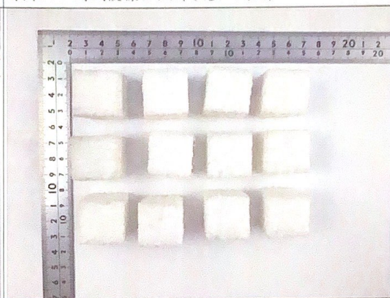
附圖七：測試後樣品照片(刮痕試驗)
