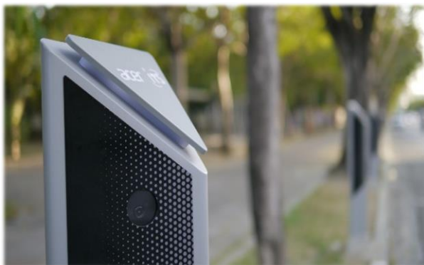
圖 10、智慧計費柱 AI 車牌辨識
