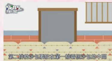
圖二、「磚牆型」砂包堆疊法
