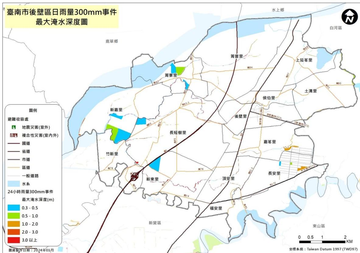
圖 2-4b-5 後壁區日雨量 300mm 事件之最大淹水深度圖
