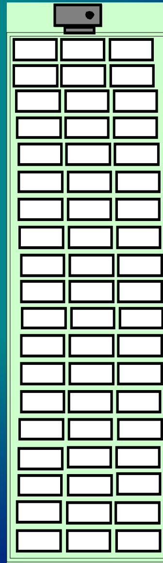
設置制震裝置
